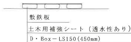
図－4 D・Boxの基本敷設断面図
