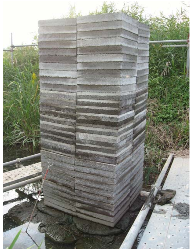
図-4 沼地(深さ約2mのヘドロ層)載荷試験でのD・BOX上のコンクリート平板の積層状態(80cm×80cm×高さ約1.9m)
