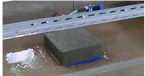
写真-5 コンクリート基礎模型の実験後の沈下状況
