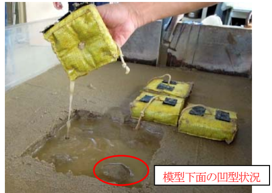
写真-6 大型特殊土のう基礎模型の実験後の状況
