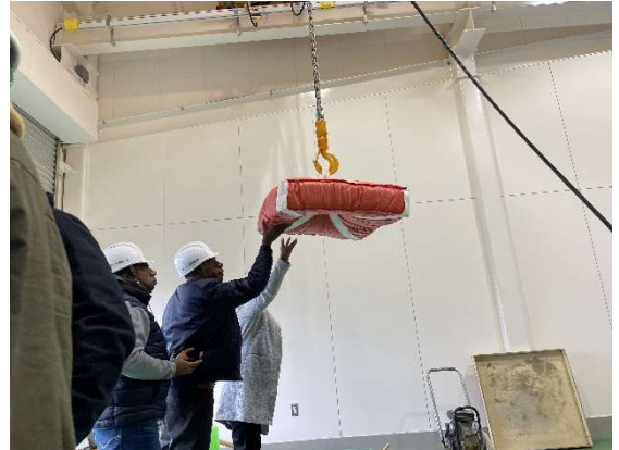
D・Box LS75 (吊上時の底の凹確認)
